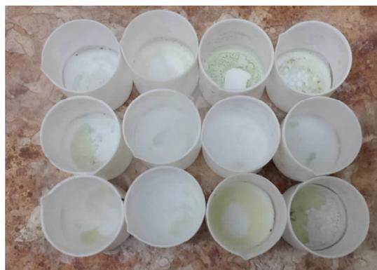
(a) 样品加混合酸在电热板上溶解蒸干
