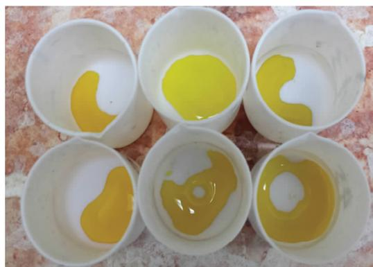
(b) 样品加混合酸溶解蒸干加王水复溶
